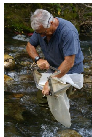
Figure 6 Prélèvement des macro-invertébrés benthiques au filet surber (Source :JI)
